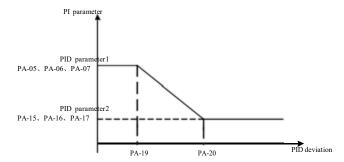
Figure 6-26 PID parameter switching
